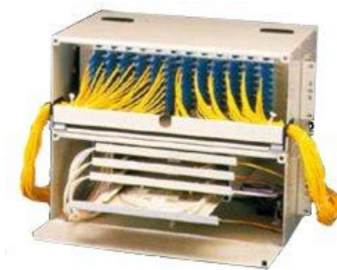
ArRepartidor 19/21" Capacidad : hasta 96 fibras Con armazones de empalme y terminación independiente Dimensiones: 431x300x172 mm
